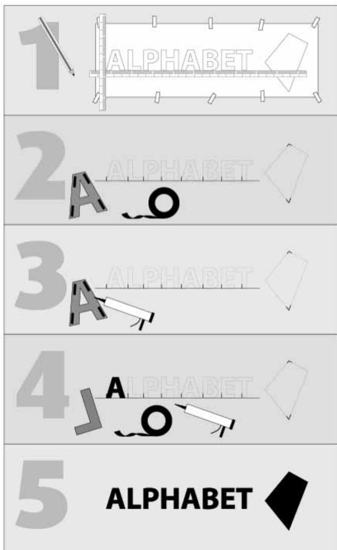
Verschiedene Montagetechniken wurden entwickelt, so dass der Schriftzug mit dem geringsten Aufwand so stabil wie möglich befestigt werden kann. Die flach konstruierten Schriftzüge lassen sich am leichtesten befestigen, da ein Klebeverfahren und Tape benutzt wird. Die größeren Box-light (CS)- Schriftzüge andererseits benötigen wegen ihres Aufbaues eine starke Befestigung.
